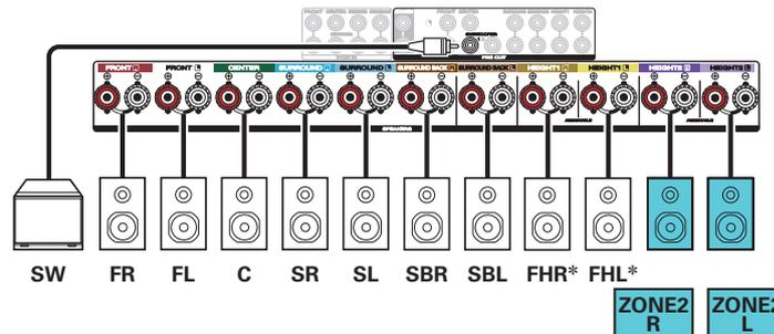
\* Die Hochtöner, die Deckenlautsprecher und die Dolby Atmos Enabled-Lautsprecher können an die HEIGHT1-Lautsprecheranschlüsse angeschlossen werden. Legen Sie über "Height" - "Layout" im Menü den anzuschließenden Lautsprecher fest. (☞ S. 209)
