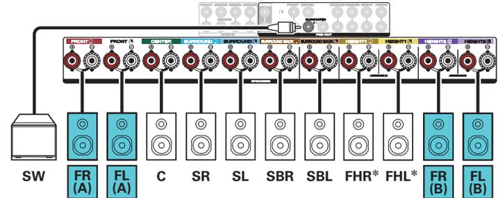
\* Die Hochtöner, die Deckenlautsprecher und die Dolby Atmos Enabled-Lautsprecher können an die HEIGHT1-Lautsprecheranschlüsse angeschlossen werden. Legen Sie über "Height" - "Layout" im Menü den anzuschließenden Lautsprecher fest. (📖 S. 209)
