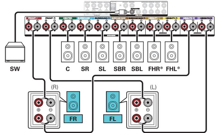
\* Die Hochtöner, die Deckenlautsprecher und die Dolby Atmos Enabled-Lautsprecher können an die HEIGHT1-Lautsprecheranschlüsse angeschlossen werden. Legen Sie über "Height" - "Layout" im Menü den anzuschließenden Lautsprecher fest. (☞ S. 209)
