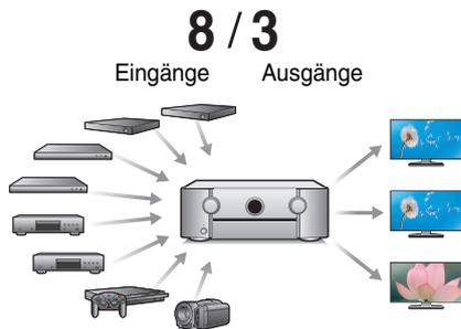
Dieses Gerät stellt für den Anschluss zahlreicher verschiedener digitaler Quellen 8 HDMI-Eingänge bereit, darunter einen an der Vorderseite, über den Sie schnell und bequem eine Videokamera, eine Spielekonsole oder ein anderes mit HDMI ausgestattetes Gerät anschließen können. Es gibt zwei HDMI-Ausgänge für den Hauptraum und einen dritten HDMI-Ausgang für ZONE2.
