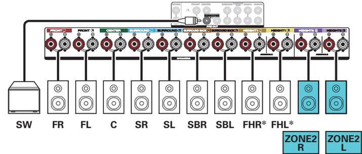
\* Die Hochtöner, die Deckenlautsprecher und die Dolby Atmos Enabled-Lautsprecher können an die HEIGHT1-Lautsprecheranschlüsse angeschlossen werden. Legen Sie über "Height" - "Layout" im Menü den anzuschließenden Lautsprecher fest. (☞ S. 216)
