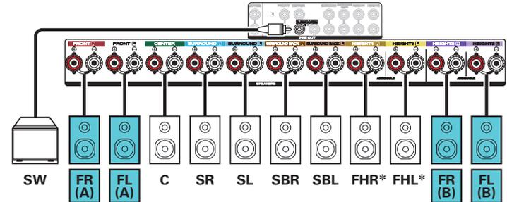
\* Die Hochtöner, die Deckenlautsprecher und die Dolby Atmos Enabled-Lautsprecher können an die HEIGHT1-Lautsprecheranschlüsse angeschlossen werden. Legen Sie über "Height" - "Layout" im Menü den anzuschließenden Lautsprecher fest. (☞ S. 216)
