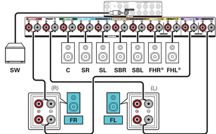
\* Die Hochtöner, die Deckenlautsprecher und die Dolby Atmos Enabled-Lautsprecher können an die HEIGHT1-Lautsprecheranschlüsse angeschlossen werden. Legen Sie über "Height" - "Layout" im Menü den anzuschließenden Lautsprecher fest. (S. 216)
