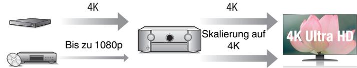
Dieses Gerät ist mit einer Skalierungsfunktion für 4K-Videodaten ausgestattet, sodass Sie analoge Videodaten oder SD (Standard Definition)-Video über HDMI mit 4K-Auflösung (3840 × 2160 Pixel) ausgeben können. Mit dieser Funktion können Sie das Gerät über ein einzelnes HDMI-Kabel an einen Fernseher anschließen und so hochauflösende Bilder für jede Videoquelle erzeugen.
