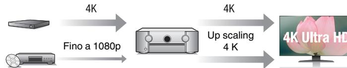
Questa unità è dotata di una funzione upscaling video 4 K che consente a un video analogico o a un video SD (Definizione Standard) di essere emessi tramite HDMI a una risoluzione 4K (3840 × 2160 pixel). Questa funzione consente al dispositivo di essere collegato a un televisore usando un unico cavo HDMI e produce immagini ad alta definizione per qualsiasi sorgente video.
