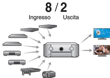
Per il collegamento a un'ampia gamma di sorgenti digitali, questa unità offre 8 ingressi HDMI, incluso 1 sul pannello anteriore che consente di collegare rapidamente e facilmente una videocamera, una console di gioco o altri dispositivi attrezzati con HDMI. C'è un'uscita HDMI per la MAIN ZONE e una seconda uscita HDMI per ZONE2.
