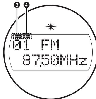
3 Si illumina quando la trasmissione è sintonizzata correttamente.
