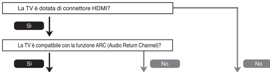
**“Collegamento 1: TV dotata di connettore HDMI e compatibile con la funzione ARC (Audio Return Channel)”** (☞ [p. 62](#))
