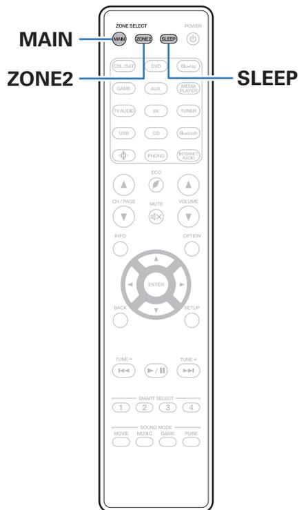
Sie können das Gerät so einstellen, dass es nach Ablauf einer festgelegten Zeit automatisch auf Standby umschaltet. Dies ist besonders angenehm, wenn man eine Quelle zum Einschlafen anzeigt oder abspielt. Die Einschlaffunktion kann für jede Zone eingerichtet werden.
