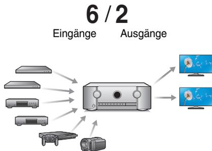
Dieses Gerät verfügt über 6 HDMI-Eingänge und 2 HDMI-Ausgänge, die Verbindungen mit verschiedenen HDMI-kompatiblen Geräten wie Blu-ray Disc-Playern, Spielekonsolen und HD-Videokameras ermöglichen. Dieses Gerät ist mit 2 Monitorausgängen ausgestattet, sodass Sie dasselbe Bild gleichzeitig noch einmal projizieren können.
