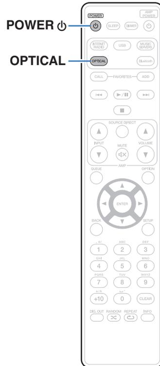
Digitale Audiosignale von einem externen Gerät können mit dem integrierten D/A-Wandler auf diesem Gerät umgewandelt und als Analogsignale ausgegeben werden. (D/A-Wandlerfunktion)
