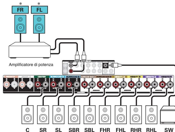
\* Quando si intende collegare diffusori a 11.1 canali, è necessario collegare un amplificatore esterno al canale anteriore, al canale posteriore o al canale surround posteriore come minimo. Impostare “Collegamento” su “Solo Uscita Pre” per il proprio canale preferito. (☞ p. 202)
