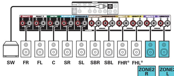
\* È possibile collegare i diffusori superiori, i diffusori a soffitto e quelli Dolby Atmos Enabled ai terminali del diffusore HEIGHT1. Impostare nel menu l'altoparlante da collegare da "Disposizione dei diffusori acustici". (p. 199)
