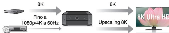
Questa unità è dotata di una funzione di upscaling video 8K che consente l'invio in uscita di un segnale video 1080p o 4K tramite HDMI alla risoluzione 8K (7680 × 4320 pixel). Questa funzione consente al dispositivo di essere collegato a un televisore usando un unico cavo HDMI e produce immagini ad alta definizione per qualsiasi sorgente video.
