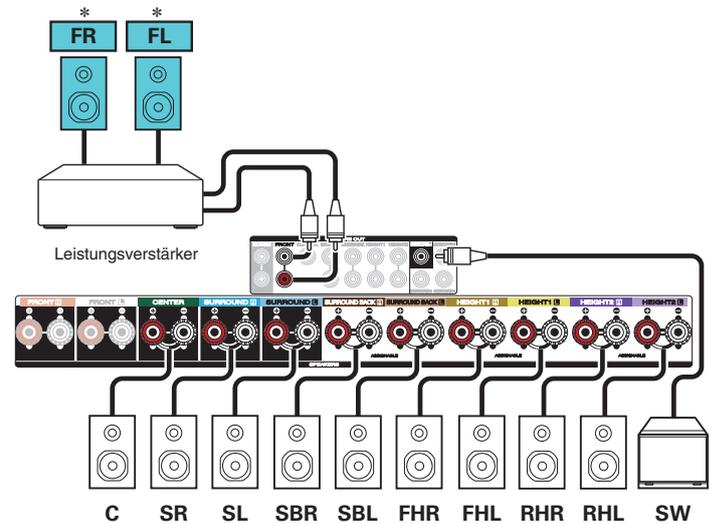
\* Beim Anschluss von 11.1-Kanal-Lautsprechern muss mindestens ein externer Verstärker an den Front-Kanal, Rear-Height-Kanal oder Surround-Back-Kanal angeschlossen werden. Stellen Sie für Ihren bevorzugten Kanal “Verbindung” auf “Nur Vorverstärker” ein. (☞ S. 201)
