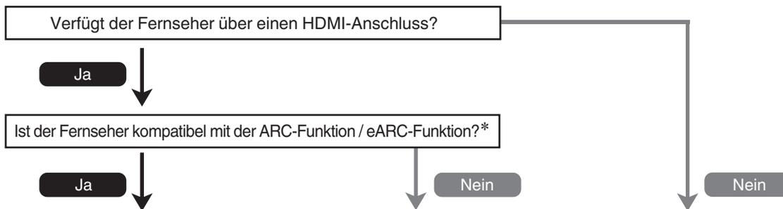
**“Anschlussweise 1: Der Fernseher verfügt über einen HDMI-Anschluss und ist kompatibel mit ARC / eARC”** (☞ S. 59)
