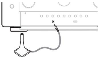
Nach dem Anschließen des Mikrofons für die Klangkalibrierung wird das folgende Fenster angezeigt.
