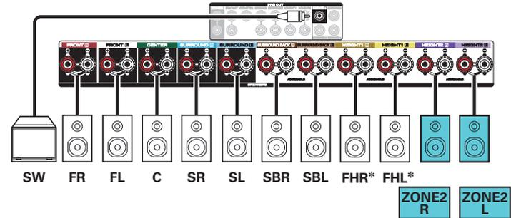
\* Die Hochtöner, die Deckenlautsprecher und die Dolby Atmos Enabled-Lautsprecher können an die HEIGHT1-Lautsprecheranschlüsse angeschlossen werden. Wählen Sie den anzuschließenden Lautsprecher im Menü unter "Lautsprecherkonfiguration" aus. (S. 198)
