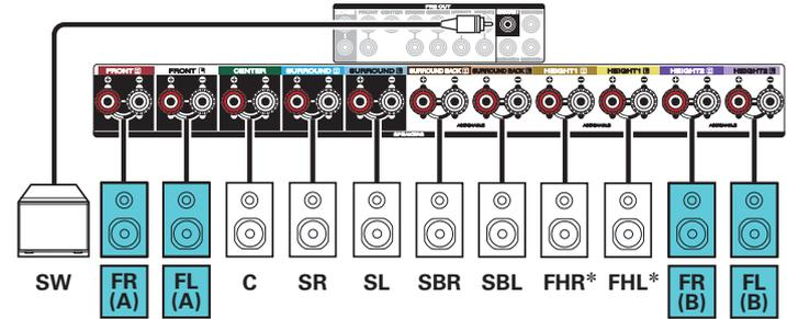
\* Die Hochtöner, die Deckenlautsprecher und die Dolby Atmos Enabled-Lautsprecher können an die HEIGHT1-Lautsprecheranschlüsse angeschlossen werden. Wählen Sie den anzuschließenden Lautsprecher im Menü unter "Lautsprecherkonfiguration" aus. (S. 198)
