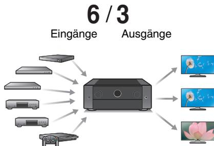
Zum Anschluss an eine breite Auswahl digitaler Quellen verfügt dieses Gerät über 6 HDMI-Eingänge, die es Ihnen ermöglichen, schnell und bequem einen Camcorder, eine Spielekonsole oder ein anderes mit HDMI ausgestattetes Gerät anzuschließen. Es gibt zwei HDMI-Ausgänge für den Hauptraum und einen dritten HDMI-Ausgang für ZONE2.
