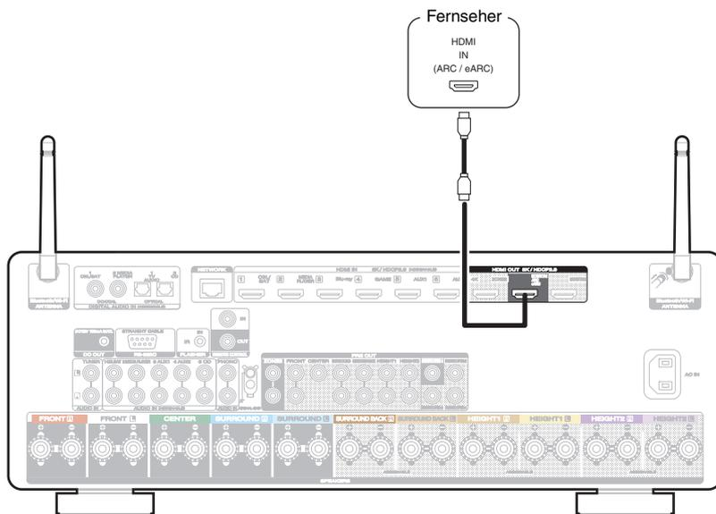
\* Für 4K-Fernseher empfehlen wir die Verwendung eines HDMI-Kabels mit der Kennzeichnung "High Speed" und "mit Ethernet".
