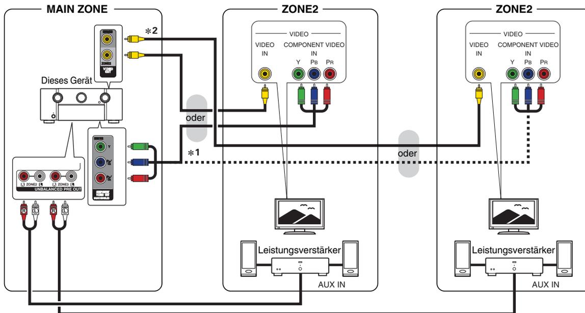
\*1 Zur Verwendung des Component-Video-Ausgangsanschlusses der MAIN ZONE für ZONE2 oder ZONE3 wählen Sie im Menü für "Analog. Video-Ausgang" - "Komponente", "ZONE2" oder "ZONE3" aus. (☞ S. 202)
