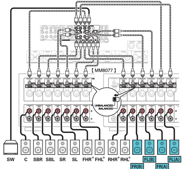
\* Die Heigt-Lautsprecher, Decken-Lautsprecher und Dolby Atmos Enabled-Lautsprecher können an die HEIGHT1- und HEIGHT2 RCA-Anschlüsse sowie an die HEIGHT1- und HEIGHT2 XLR-Anschlüsse angeschlossen werden. Wählen Sie den anzuschließenden Lautsprecher im Menü unter "Height" aus. (☞ S. 225)
