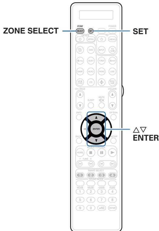
Wenn ZONE SELECT gedrückt wird, kann nur die eingestellte Zone mit der Fernbedienung bedient werden.
