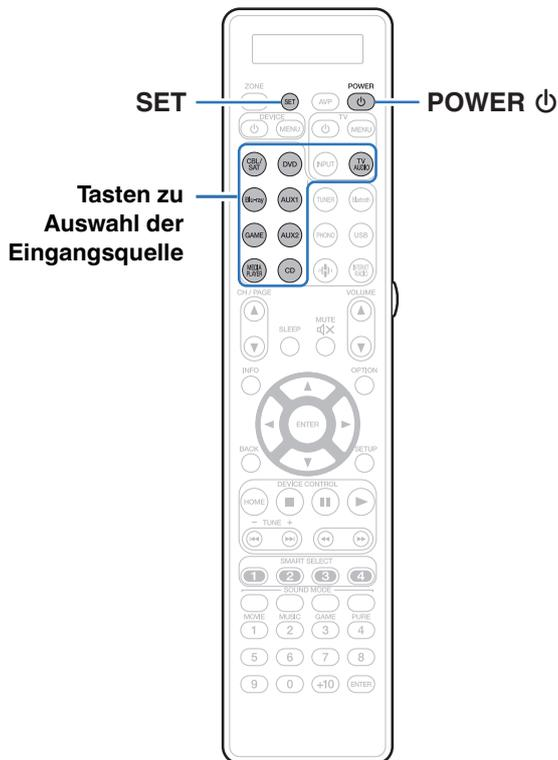
Wenn das Gerät nicht funktioniert, selbst wenn der voreingestellte Code registriert ist, verwenden Sie die Lernfunktion. Es können Fernbedienungs-codes für verschiedene Geräte zur Verwendung durch die Marantz-Fernbedienung, die mit diesem Gerät geliefert wurde, gespeichert werden.
