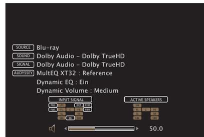
Drücken Sie erneut INFO, während der Informationsbildschirm angezeigt wird, um Informationen zu den Videoeingangs- und Videoausgangssignalen anzuzeigen. Die FRL Bandbreite wird angezeigt, wenn die Einstellung "4K/8K Signal Format" dieses Geräts "8K Erweitert" lautet und der angeschlossene Fernseher den FRL-Übertragungsmodus unterstützt.
