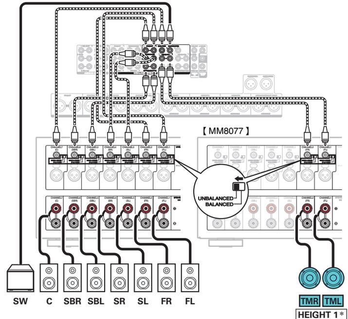
\* Anstelle der Top-Middle-Lautsprecher können die Top-Front- oder Top-Rear-Lautsprecher angeschlossen werden. Legen Sie in diesem Fall unter "Height" - "Layout" im Menü die anzuschließenden Deckenlautsprecher fest. (☞ S. 225)
