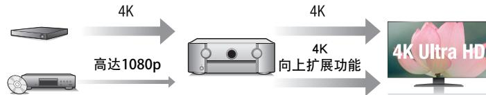
本机配有允许模拟视频或 SD (Standard Definition) 视频以 4K (3840×2160 像素) 通过 HDMI 进行输出的 4K 视频升级功能。此功能使设备可通过单根 HDMI 电缆连接到电视，并可产生任何视频源的高清晰度图像。
