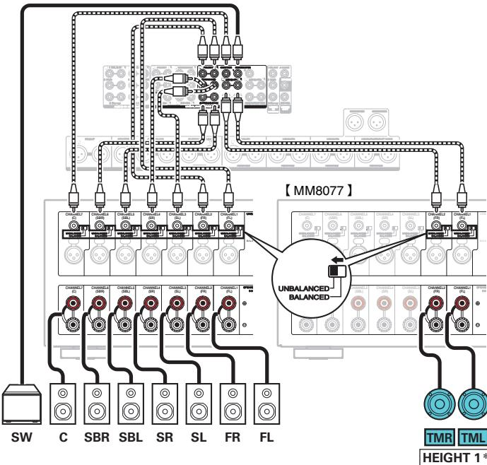
\* 可以连接顶部前置或顶部后置扬声器，除了顶部中置扬声器。在这种情况下，请在菜单中“高度” - “布局”下设置要连接的天花板扬声器。[\(第 222 页\)](#)
