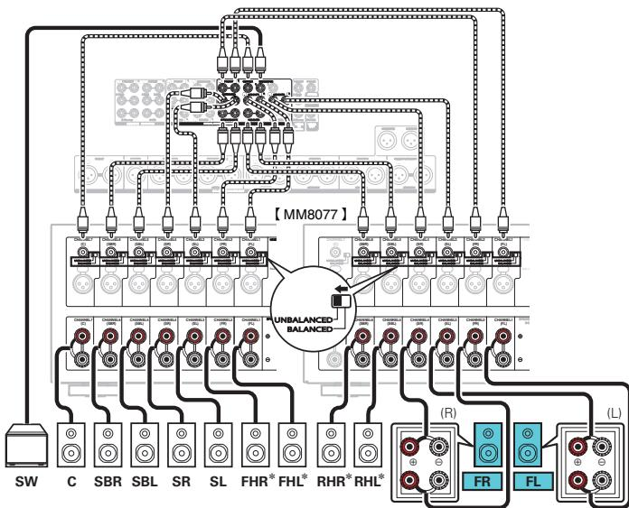
\* 可以将纵向扬声器、天花板扬声器和 Dolby Atmos Enabled 扬声器连接至 HEIGHT1 和 HEIGHT2 RCA 端子或 HEIGHT1 和 HEIGHT2 XLR 端子。请通过菜单中的“高度”设置要连接的扬声器。（[第 222 页](#)）
