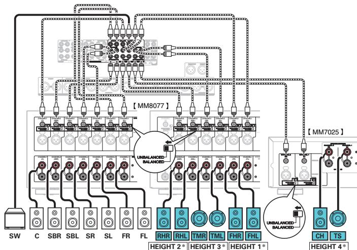
\* 使用环绕纵向扬声器进行最佳效果的 Auro-3D 播放。安装后置纵向扬声器替代环绕纵向扬声器欣赏 Auro-3D 和 Dolby Atmos 的 13.1 声道播放。
