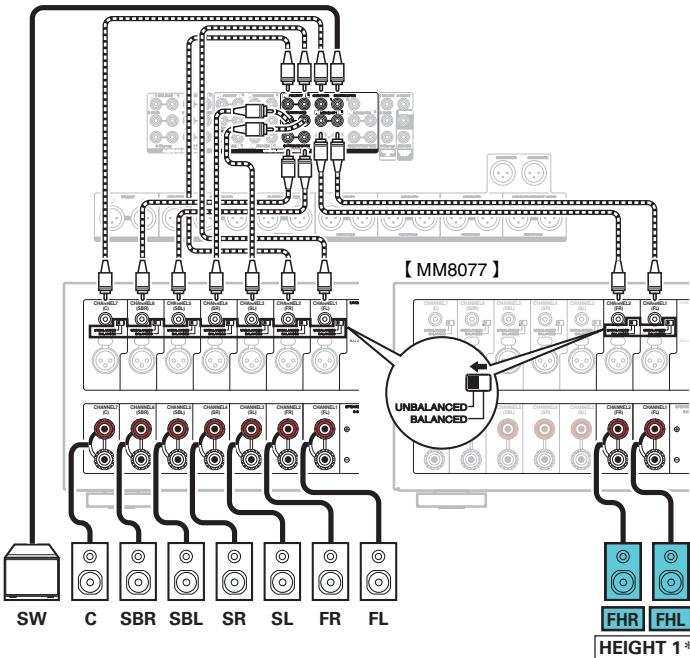
\* 可以连接后置纵向扬声器，除了前置纵向扬声器。在这种情况下，请在菜单中“高度” - “布局”下设置要连接的纵向扬声器。(参见第 222 页)
