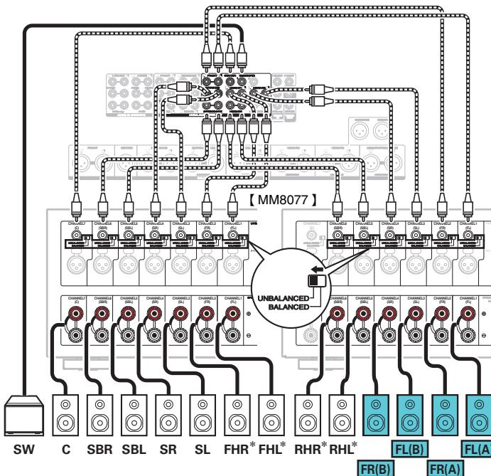
\* 可以将纵向扬声器、天花板扬声器和 Dolby Atmos Enabled 扬声器连接至 HEIGHT1 和 HEIGHT2 RCA 端子或 HEIGHT1 和 HEIGHT2 XLR 端子。请通过菜单中的“高度”设置要连接的扬声器。（[参见 第 222 页](#)）
