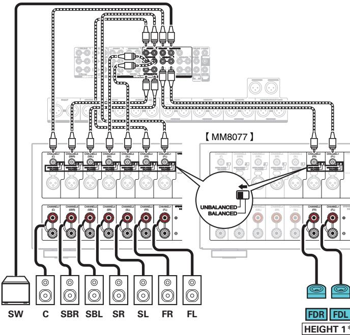
\* 可以连接环绕 Dolby 或后置 Dolby 扬声器，除了前置 Dolby 扬声器。在这种情况下，请在菜单中“高度” - “布局”下设置要连接的 Dolby Atmos Enabled 扬声器。(参见第 222 页)
