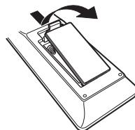
**2 按照指示将两节电池正确插入电池匣内。**
