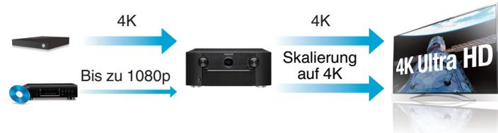
Dieses Gerät ist mit einer Skalierungsfunktion für 4K-Videodaten ausgestattet, sodass Sie analoge Videodaten oder SD-Video (Standard Definition) über HDMI mit 4K-Auflösung (3840 × 2160 Pixel) ausgeben können. Mit dieser Funktion können Sie das Gerät über ein einzelnes HDMI-Kabel an einen Fernseher anschließen und so hochauflösende Bilder für jede Videoquelle erzeugen.
