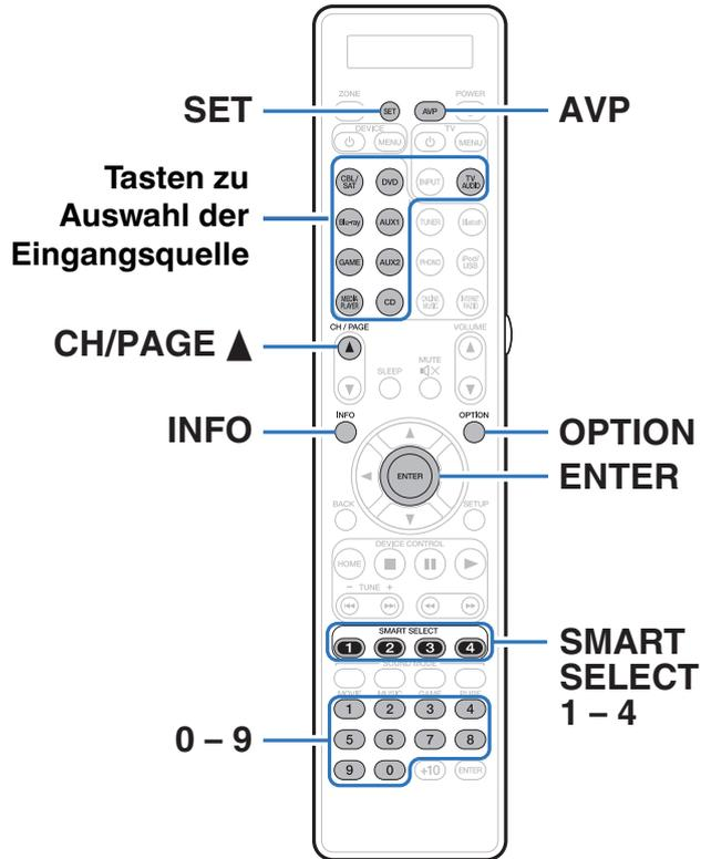
Wenn in der beiliegenden Fernbedienung voreingestellte Codes programmiert sind, kann sie zur Steuerung der von Ihnen genutzten Geräte, wie z. B. DVD-Player oder Fernsehgeräte von verschiedenen Herstellern, verwendet werden.
