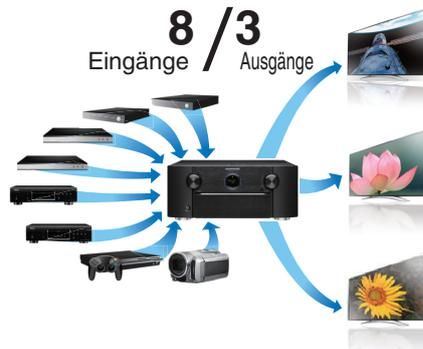
Dieses Gerät stellt für den Anschluss zahlreicher verschiedener digitaler Quellen 8 HDMI-Eingänge bereit, darunter einen an der Vorderseite, über den Sie schnell und bequem eine Videokamera, eine Spielekonsole oder ein anderes mit HDMI ausgestattetes Gerät anschließen können. Es gibt zwei HDMI-Ausgänge für den Hauptraum und einen dritten HDMI-Ausgang für einen weiteren Raum.
