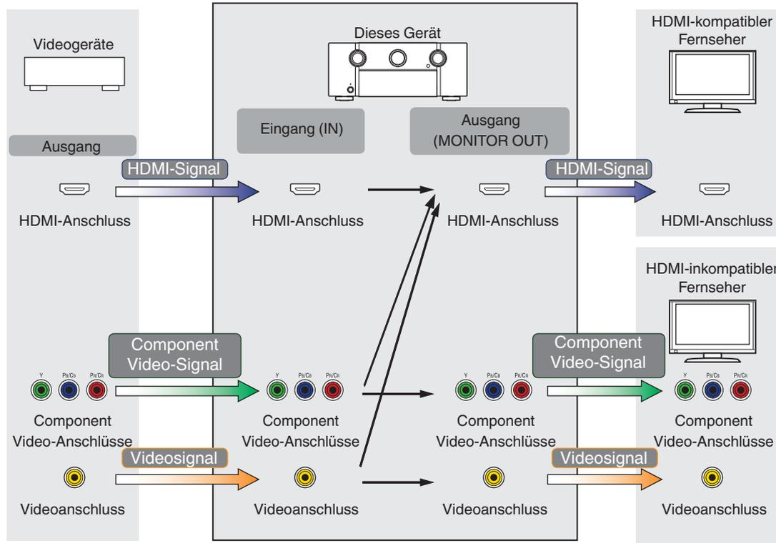
Die Videoumwandlungsfunktion der Hauptzone unterstützt folgende Formate : NTSC, PAL, SECAM, NTSC4.43, PAL -N, PAL-M und PAL-60.
