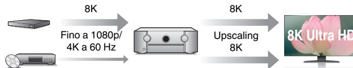
Questa unità è dotata di una funzione di upscaling video 8K che consente l'invio in uscita di un segnale video SD (Standard Definition), HD (High Definition) o 4K a 60 Hz su collegamento HDMI alla risoluzione 8K (7680 × 4320 pixel). Questa funzione consente al dispositivo di essere collegato a un televisore usando un unico cavo HDMI e produce immagini ad alta definizione per qualsiasi sorgente video.
