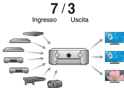
Per il collegamento a un'ampia gamma di sorgenti digitali, questa unità offre 7 ingressi HDMI, che consentono di collegare rapidamente e comodamente un camcorder, una console per videogiochi o altri apparecchi dotati di connettore HDMI. Ci sono uscite HDMI doppie per la stanza principale e una terza uscita HDMI per ZONE2.
