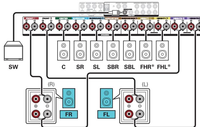
\* È possibile collegare i diffusori superiori, i diffusori a soffitto e quelli Dolby Atmos Enabled ai terminali del diffusore HEIGHT1. Impostare il diffusore da collegare in "Superiore" - "Disposizione" nel menu. (☞ p. 209)
