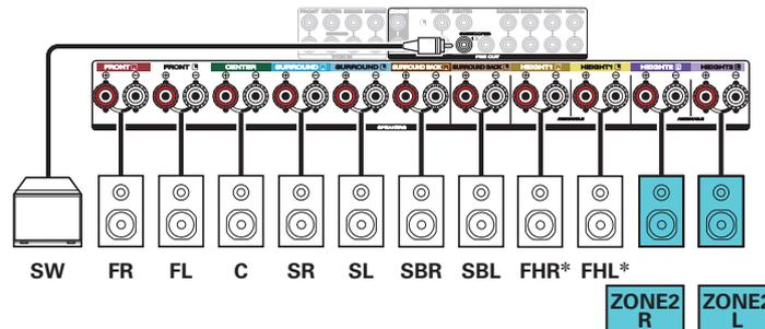
\* È possibile collegare i diffusori superiori, i diffusori a soffitto e quelli Dolby Atmos Enabled ai terminali del diffusore HEIGHT1. Impostare il diffusore da collegare in "Superiore" - "Disposizione" nel menu. (☞ p. 209)
