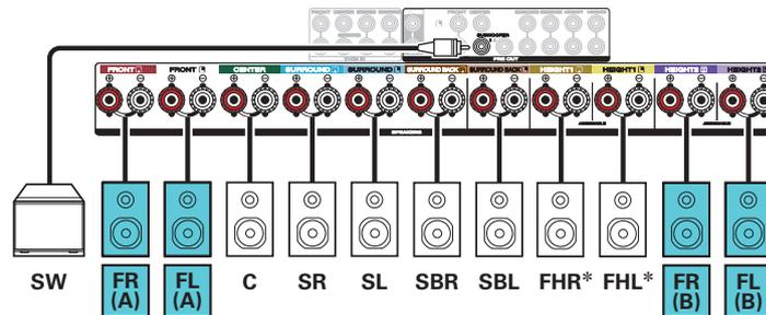
\* È possibile collegare i diffusori superiori, i diffusori a soffitto e quelli Dolby Atmos Enabled ai terminali del diffusore HEIGHT1. Impostare il diffusore da collegare in "Superiore" - "Disposizione" nel menu. (☞ p. 209)
