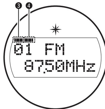
❸ Si illumina quando la trasmissione è sintonizzata correttamente.
