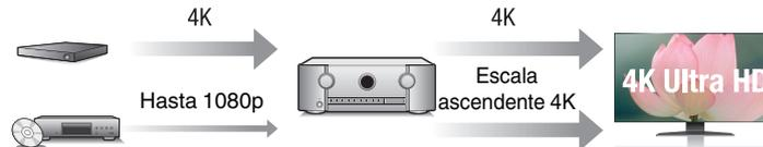
Esta unidad está equipada con una función de escalado de video de 4K que permite la salida de video analógico o SD (Standard Definition) a través de HDMI a una resolución de 4K (3.840 × 2.160 píxeles). Esta función habilita la conexión del dispositivo al TV utilizando un solo cable HDMI y produce imágenes en alta definición para cualquier fuente de video.
