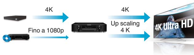
Questa unità è dotata di una funzione upscaling video 4 K che consente a un video analogico o a un video SD (Definizione Standard) di essere emessi tramite HDMI a una risoluzione 4K (3840 × 2160 pixel). Questa funzione consente al dispositivo di essere collegato a un televisore usando un unico cavo HDMI e produce immagini ad alta definizione per qualsiasi sorgente video.
