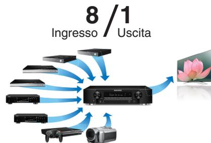
Questa unità è dotata di 8 ingressi HDMI e 1 uscita HDMI che consentono il collegamento a vari dispositivi compatibili con HDMI, quali lettori Blu-ray Disc, console per giochi e videocamere HD.
