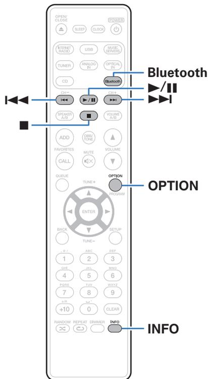
スマートフォンやデジタル音楽プレーヤーなどの Bluetooth 機器と本機をペアリングして接続すると、Bluetooth 機器の音楽ファイルをワイヤレスで楽しむことができます。約 30m の範囲内で通信できます。
