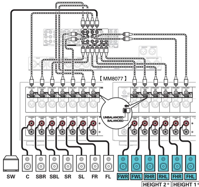
\* Puede cambiar la combinación de los canales HEIGHT1 y HEIGHT2 en la configuración. (☞ p. 73)
