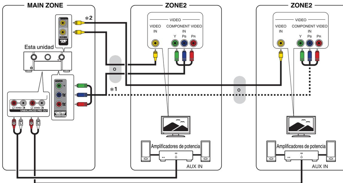
\*1 Establezca "ZONE2" o "ZONE3" para "Salida vídeo analog." - "Componente" en el menú para permitir el uso del terminal de salida de vídeo por componentes MAIN ZONE para ZONE2 o ZONE3. (ícono p. 202)
