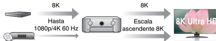
Esta unidad está equipada con una función de escalado de vídeo de 8K que permite la salida de vídeo SD (Standard Definition) o HD (High Definition)/4K 60 Hz a través de HDMI a una resolución de 8K (7680 x 4320 píxeles). Esta función habilita la conexión del dispositivo al TV utilizando un solo cable HDMI y produce imágenes en alta definición para cualquier fuente de vídeo.
