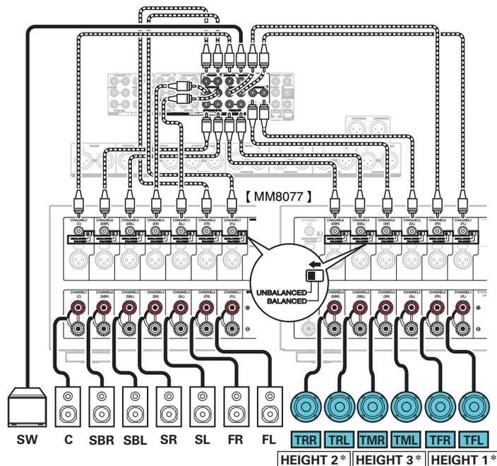
\* Puede cambiar la combinación de los canales HEIGHT1, HEIGHT2 y HEIGHT3 en la configuración. (☞ p. 73)
