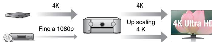
Questa unità è dotata di una funzione upscaling video 4K che consente a un video analogico o a un video SD (Standard Definition) di essere riprodotti tramite HDMI a una risoluzione 4K (3840 × 2160 pixel). Questa funzione consente al dispositivo di essere collegato a un televisore usando un unico cavo HDMI e produce immagini ad alta definizione per qualsiasi sorgente video.
